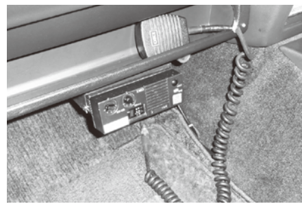
(防災用車載無線機)
