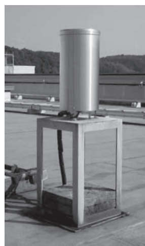
雨量計(庁舎屋上)
