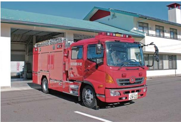
中消防署川辺出張所に新型の消防タンク車が納車されました。このタンク車は、筒先から薬液と水を混合した泡を噴射することができ、効果的に消火を行うことができます。また、この泡は田畑や河川に浸水しても害のない成分となっており、環境にも配慮した装備です。
