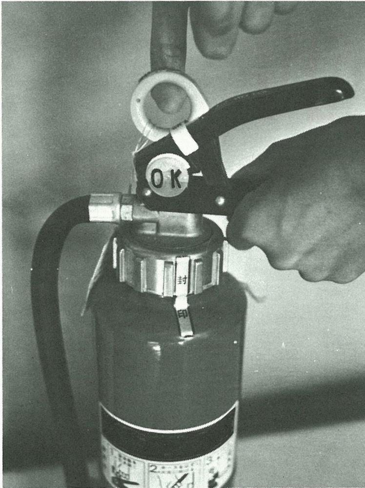
12月1日からは消火器の規格が変わり、安全ピン栓は「上抜き」に統一されます。ピンの下の「OKマーク」は使用済であるか否かの表示装置（表示方法はメーカーによってさまざま）
