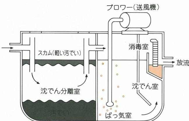
とには変わりなく「浄化槽は生き物」と言われるるのはこのためです。しかし、腐敗方式は悪臭が残つたり効率が悪いために、ばつ氣方式の方が多く普及しています。
