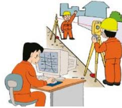
測量の基礎となる基準点を設置し、一筆ごとの土地の境界(筆界)を測量し、測量後に土地の面積を計算します。その後、必要事項を表示した地籍図の原図を作成します。
